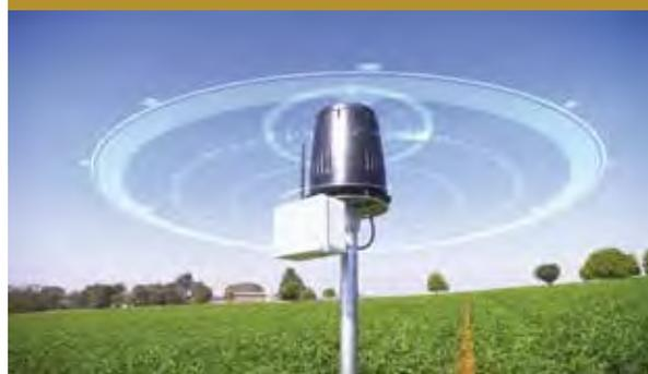
Módulo que é instalado em cada talhão do cultivo. É um sensor que mede variáveis como umidade, temperatura do solo e pluviosidade. Tudo de forma automática
