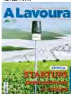
Módulo AgroSmart instalado em cultivo com sensores que medem, de forma automática, umidade, temperatura do solo e pluviosidade [www.agrosmart.com.br](http://www.agrosmart.com.br)
